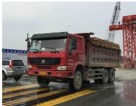
渣车封闭运输
