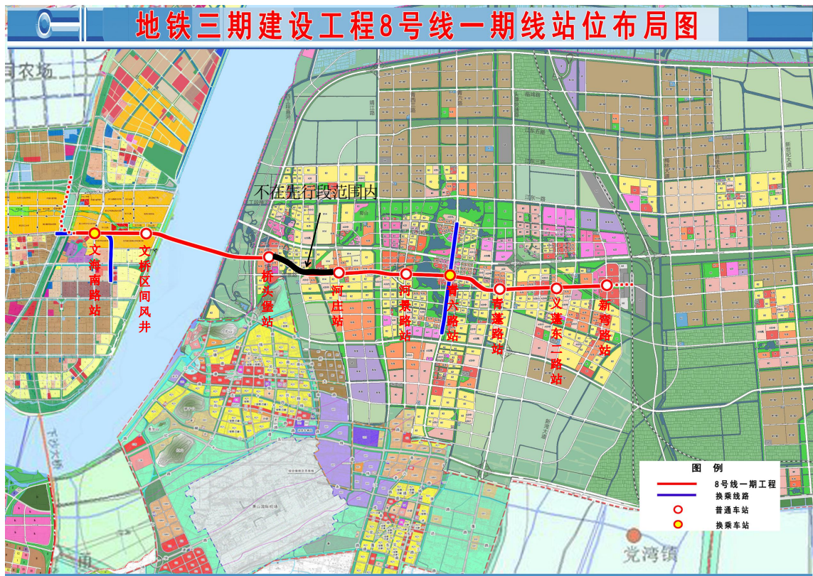
图 1-1 杭州地铁 8 号线一期工程先行段走向示意图
